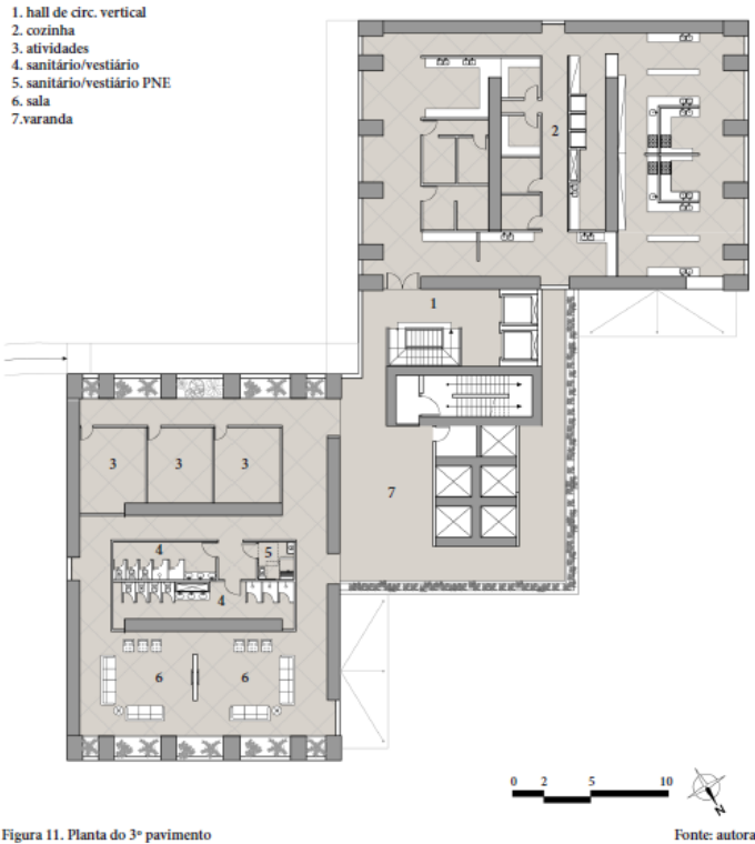
Figura 11. Planta do 3º pavimento
