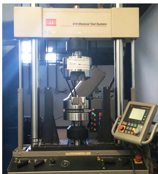
Figura 3 - Máquina MTS 810 (Material Test System, EUA), utilizada para a ciclagem mecânica das amostras.
