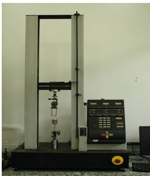
Figura 2 - Máquina INSTRON 4411, utilizada para avaliação dos testes de resistência à tração das amostras.
