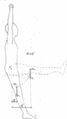
FIGURA 13B - Modelo de exercício abdominal de elevação simultânea de membros inferiores com o corpo suspenso em espaldar sueco. CF = articulação coxo-femoral, CGi = centro de gravidade dos membros inferiores, Pi = peso dos membros inferiores, d = braço de alavanca na posição 1, d' = braço de alavanca na posição 2.
