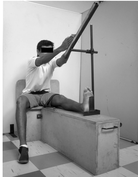
Figura 3. Exemplo de execução do teste no Banco para a Avaliação da Flexibilidade
