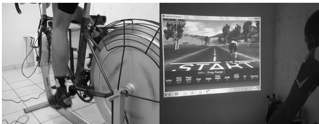
Figura 1. Representação do aparelho Velotron™ Dynafit Model, Racer Mate®USA, e seu sistema de visualização.
